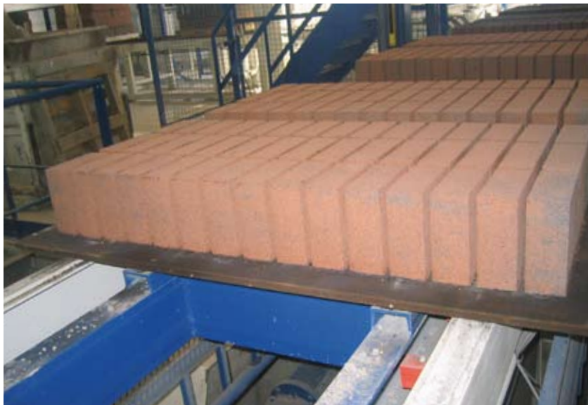
Las bandejas metálicas consiguen que la calidad geométrica de las piezas sea mayor
